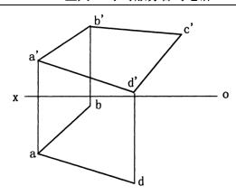
五、求作平面 ABCD 对 H 面的最大斜度线 CD (AB 为水平线),并求平面对 H 面的倾角。(本大题共 8 分) 16.
