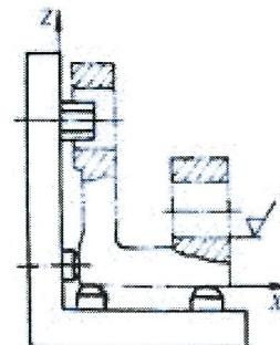
46. 右图的结构设计不合理，请画出正确的结构图。
