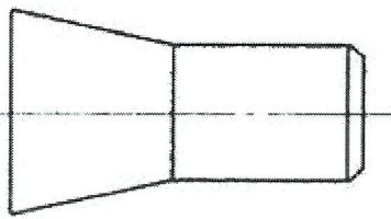
48. 右图的结构设计不合理, 请画出正确的结构。
