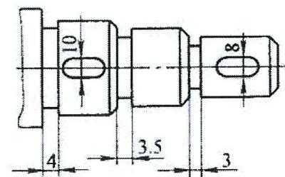
47. 右图的结构设计不合理, 请画出正确的结构。
