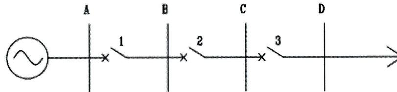
47. 试根据电流保护 III 段的阶梯配合特性，求下图中各保护的的动作时间，并说明哪些保护需要加装方向元件。
